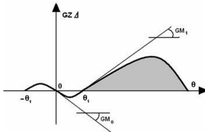
Bien qu'il ne mesure pas la véritable valeur du **GM**, le **GM-METER**, grâce à la mesure de la gîte à la position d'équilibre, calcule bien la courbe de stabilité résiduelle exacte, avec laquelle il effectue la vérification des critères. Le résultat est donc toujours conforme à la réalité, à part la valeur du **GM** et donc le critère de hauteur métacentrique minimum admissible qui peut être donné vérifiée à tort.
